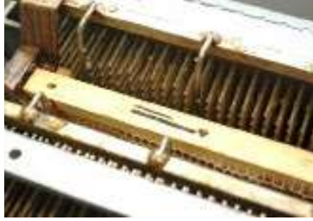
Abb. 08 - Die 1.600 biegsamen und einzeln gefederten Kunststoffspitzen pro Seite verflüssigen den thixotropen Honig in jeder einzelnen Zelle. Foto: H. Schäfer
