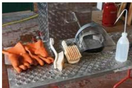
Abb.09 - Arbeitssicherheit wird großgeschrieben: Säurefeste Handschuhe, ein Schutzvisier und eine Spülflasche, um Laugenspritzer abzuspritzen, gehören dazu. Außerdem zum Reinigen laugenfeste Bürsten aus dem Fleischereizubehör und Edelstahlrahtwolle. Foto: H. Schäfer
