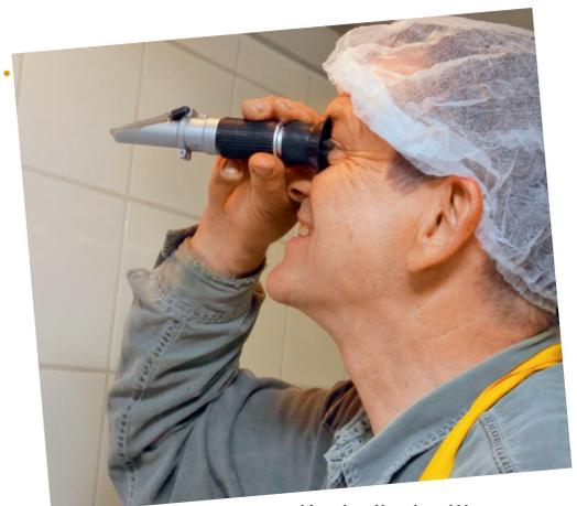
Kontrolle des Wassergehalts mit dem Refraktometer.
