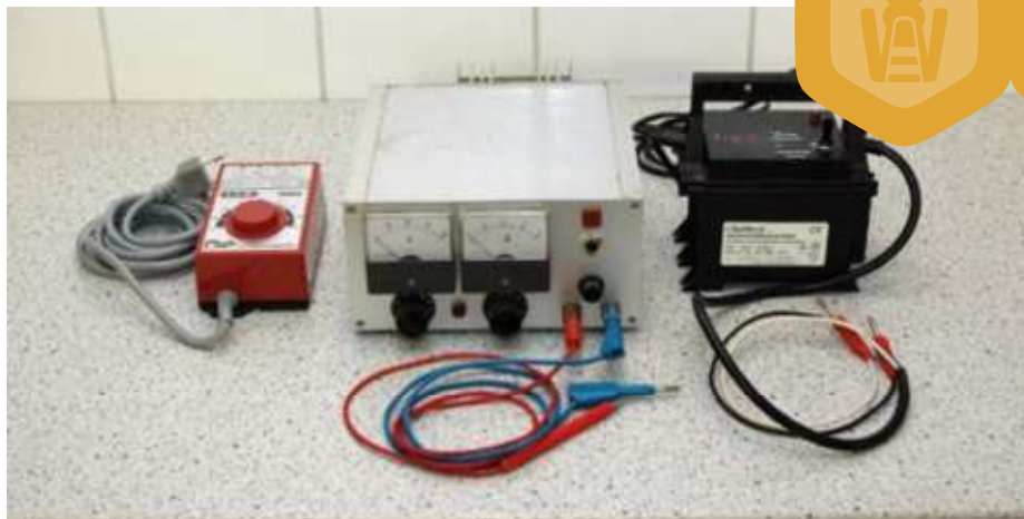
Abb. 10 - Verschiedene Trafos zum Einlöten der Mittelwände - (v.l.) Eisenbahntrafo, selbstgebautes Netzteil, Einlötrafo aus dem Fachhandel
